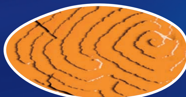
Surface d'un cristal biologique végétal présentant des fautes d'emplacements vues par microscopie à force atomique. © IUCr - journals
